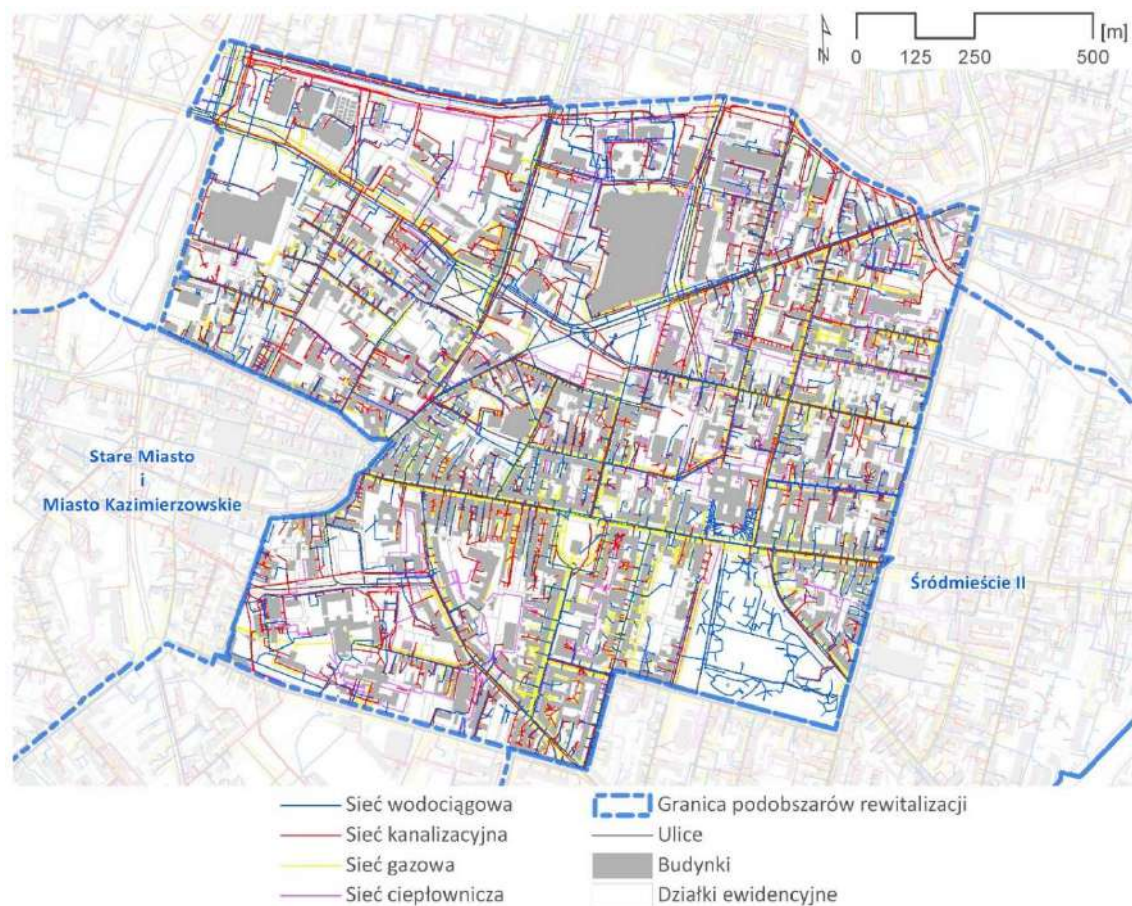
Rys. 41 Rozmieszczenie infrastruktury technicznej na podobszarze Śródmieście I
